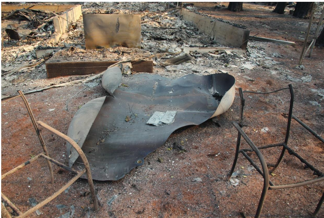
Propane tank after BLEVE.
